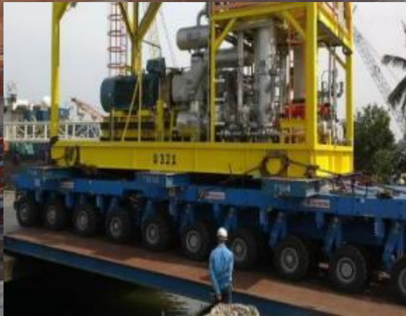
プラント用ガスコンプレッサー輸送
